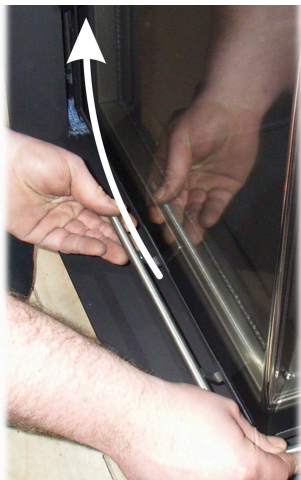
Abb. 8: Schließen der Eck- Feuerungstür links
